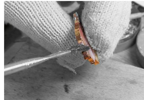
Ил. 25. Нанесение паяльного жира на торец витража
