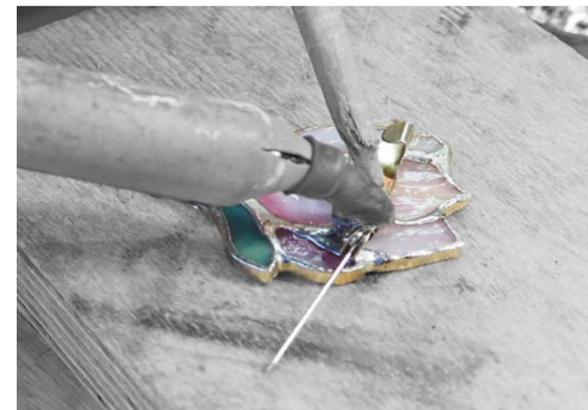
Ил. 27. Закрепление булавки
