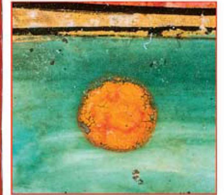
Ил. 6 в ▼ Исследование элементного состава образца авторского оранжевого красочного слоя с изображения цветов поэма методом СЭМ-ЭДС. В составе идентифицированы реальгар, свинцовые белила, а также отдельные частицы крокоита и киновари
