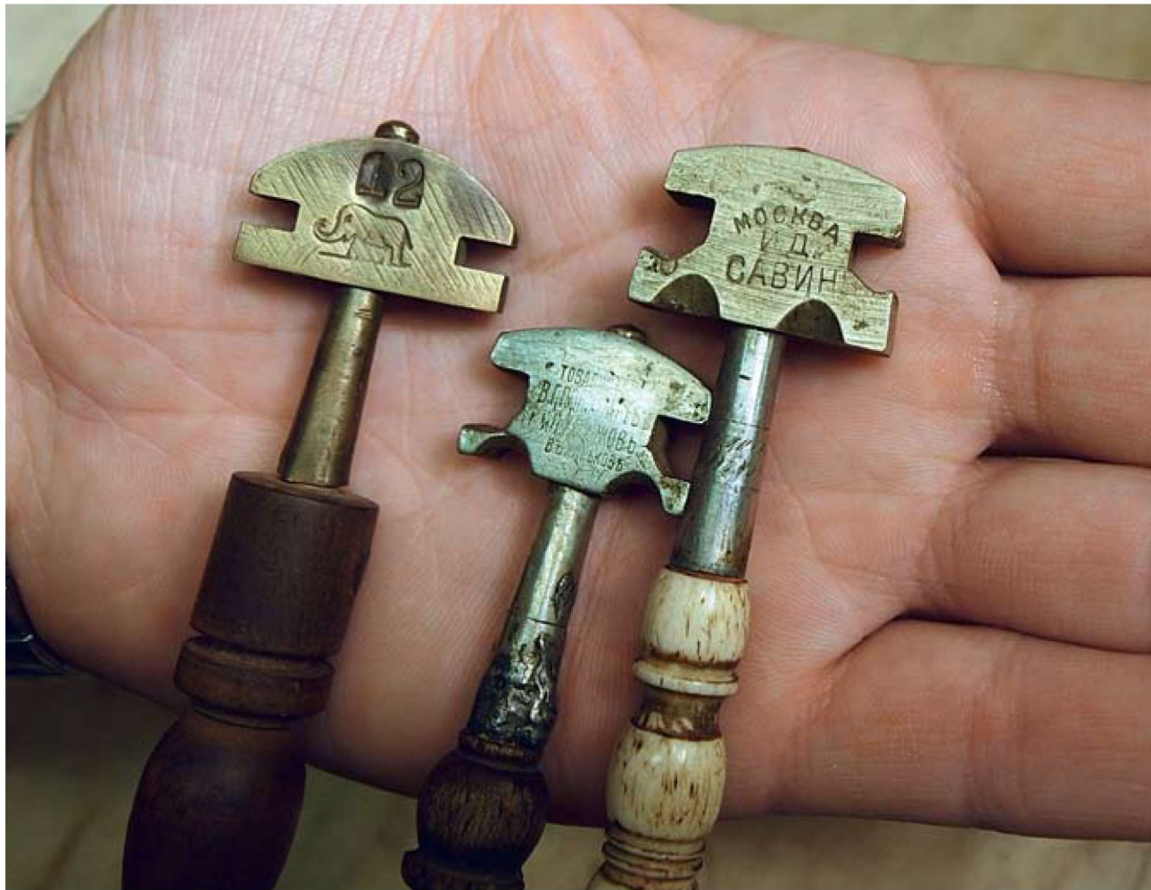
Ил. 10. Антикварные стеклорезы из собрания Л. Ю. Лифшица. Форма стеклорезов с алмазом оставалась неизменной до конца XX века. Рез велся под прямым углом к стеклу строго определенной стороной инструмента к направляющей линейке. Одна сторона рукоятки имела скос или пометку в виде маленького кружка – место для большого пальца. В ином положении алмаз не оставлял царапин. Прямоугольные канавки служили для отламывания от кромки мелких кусочков стекла. Современные витражисты используют более универсальные маневренные стеклорезы с маленьким острым твердосплавным колесиком
