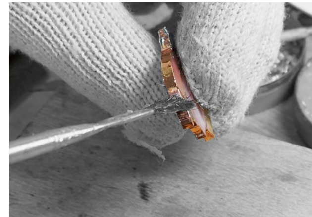
Ил. 25. Нанесение паяльного жира на торец витража
