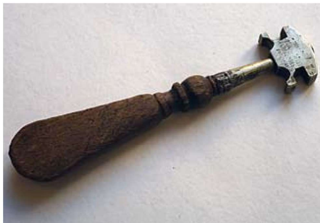
▼ Алмазный стеклорез начала XX века с клеймом крупнейшего магазина скобяных и металлических изделий товарищества В. Г. Паномарева и П. П. Рыжова в г. Харькове. Собрание автора
